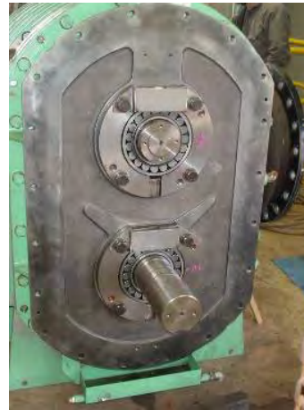
ケーシング取外し
